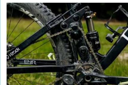
THE ENR'S I-TRACK HIGH-PIVOT SUSPENSION UTILISES AN IDLER PULLEY TO MANAGE CHAIN-GROWTH OF THE VERY REARWARD WHEEL PATH.
